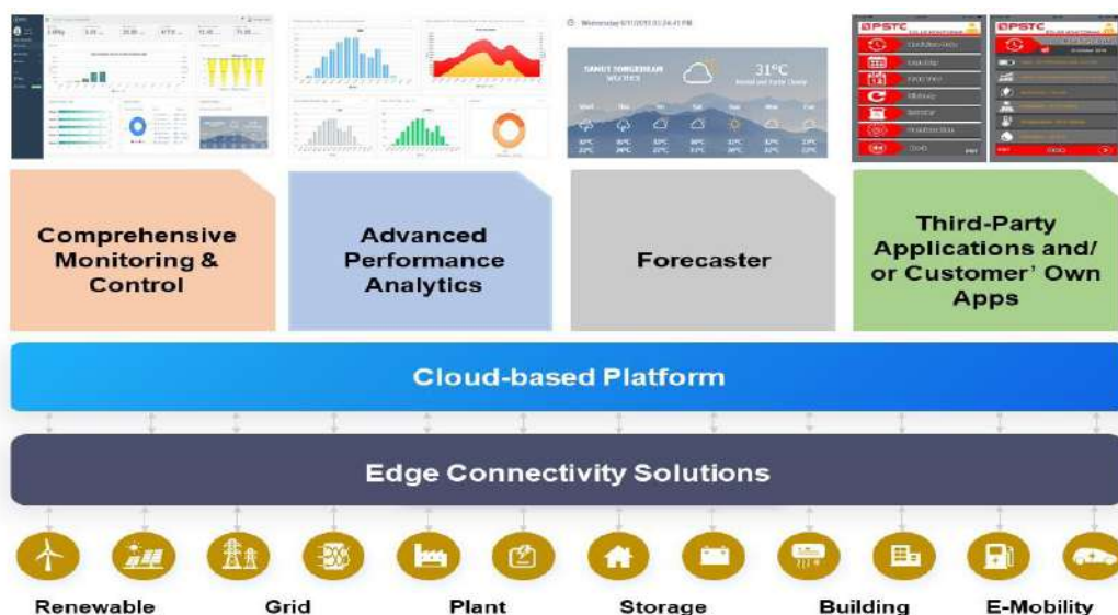
ตัวอย่าง โครงสร้างระบบตรวจสอบและวิเคราะห์ข้อมูลแบบ Real-time (SCADA) ที่บริษัทจำหน่ายและให้บริการ
